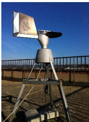
уређај за мерење полена – кров зграде Електротимока
