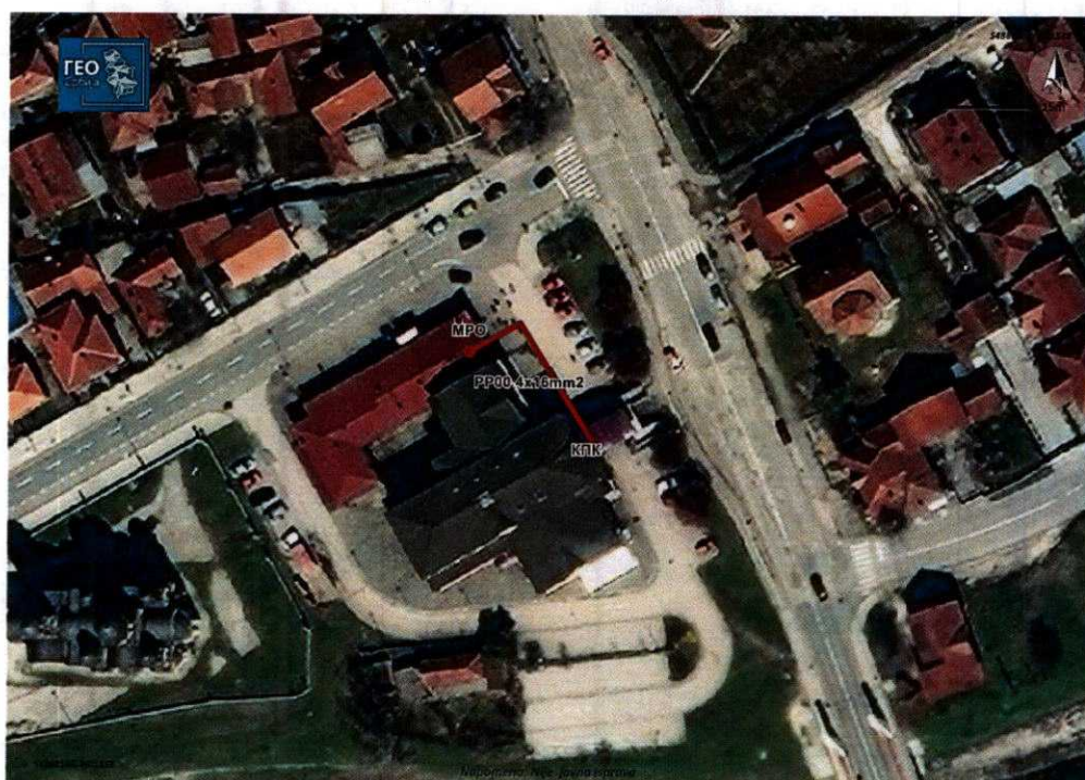
подземни кабл 0,4 kV од КПК на фасади објекта Дома културе поред улаза у објекат до МРО у улазном холу за апотеку и пошту
