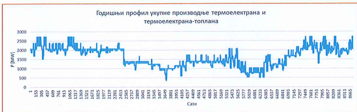
Слика 2.2 – Годишњи профил укупне производње термоелектрана и термоелектрана-топлана пре прикључења објеката из текућег интервала
