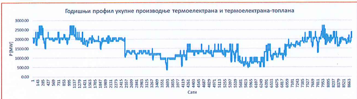
Слика 3.2 – Годишњи профил укупне производње термоелектрана и термоелектрана-топлана уз уважавање објеката из текућег интервала
