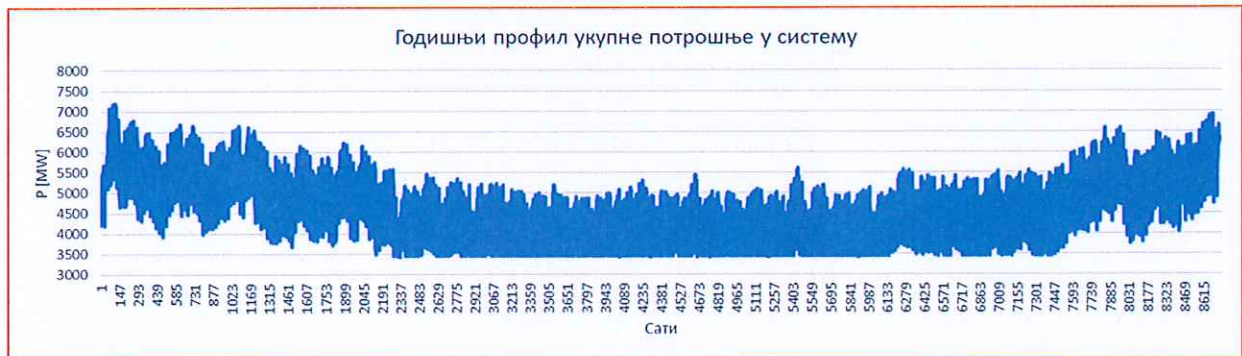
Слика 3.1 – Годишњи профил укупне потрошње у систему уз уважавање потрошачких објеката из текућег интервала
