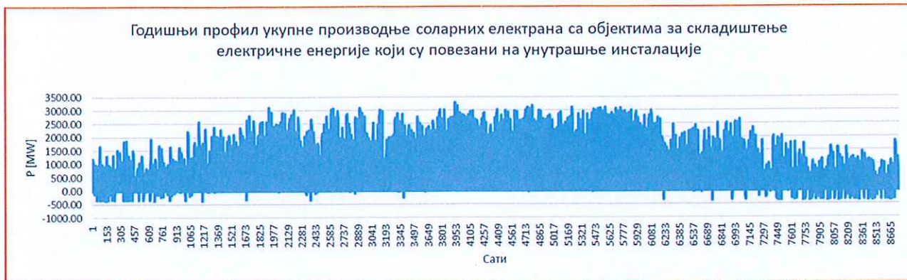
Слика 3.5 – Годишњи профил укупне производње соларних електрана са објектима за складиштење електричне енергије уз уважавање објекта из текућег интервала
