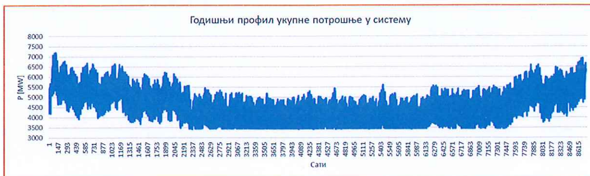
Слика 2.1 – Годишњи профил потрошње у систему пре прикључења објеката из текућег интервала
